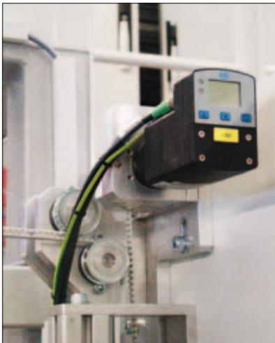
DriveLine Stellantriebe sichern beim On-the-fly-Produktionswechsel die präzise Produktposition.
