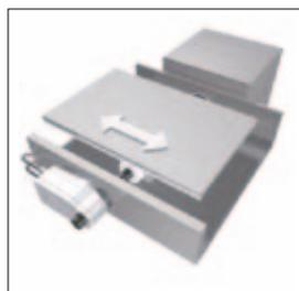
**Indirekte Positionierung:** Wirkung indirekt (abgewinkelt) über Zahnrad oder Schneckengetriebe auf Zahnstangen.
