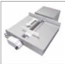
**Direkte Positionierung:** Wirkung direkt über die Achse bzw. Spindel. Das Wirkungsprinzip entspricht dem eines Kreuztischs bzw. von Linearführungen.
