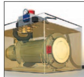
Bei MagLine Roto erfasst das Messsystem selbst im Ölbad zuverlässig die Drehzahl von Motoren und leitet diese an Steuerungen weiter. Einsatz z.B. als Motorfeedback.
