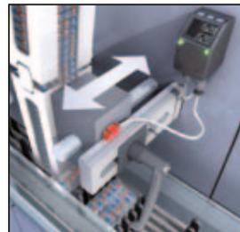
Überwachte Formatverstellung an Schieberverstellungen durch elektronische Positionsanzeigen.
